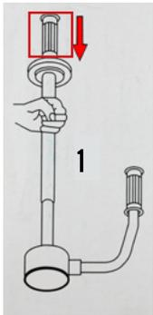
1.- Inserte el tornillo roscado de la agarradera superior de color negro en el orificio con rosca que se encuentra en el tubo de color rojo. Gire ésta agarradera en sentido a las manecillas del reloj y apriete completamente.
