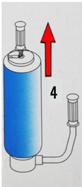
4.- Ajuste la altura del tubo de color rojo tirando de la agarradera hacia afuera, sin separar ambos tubos.
